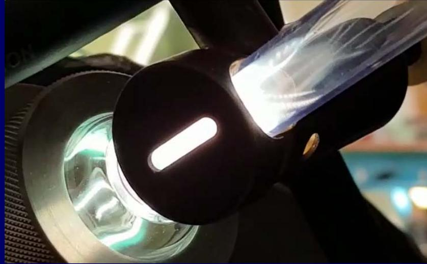
Plasma de Kriptón con descarga de microondas
