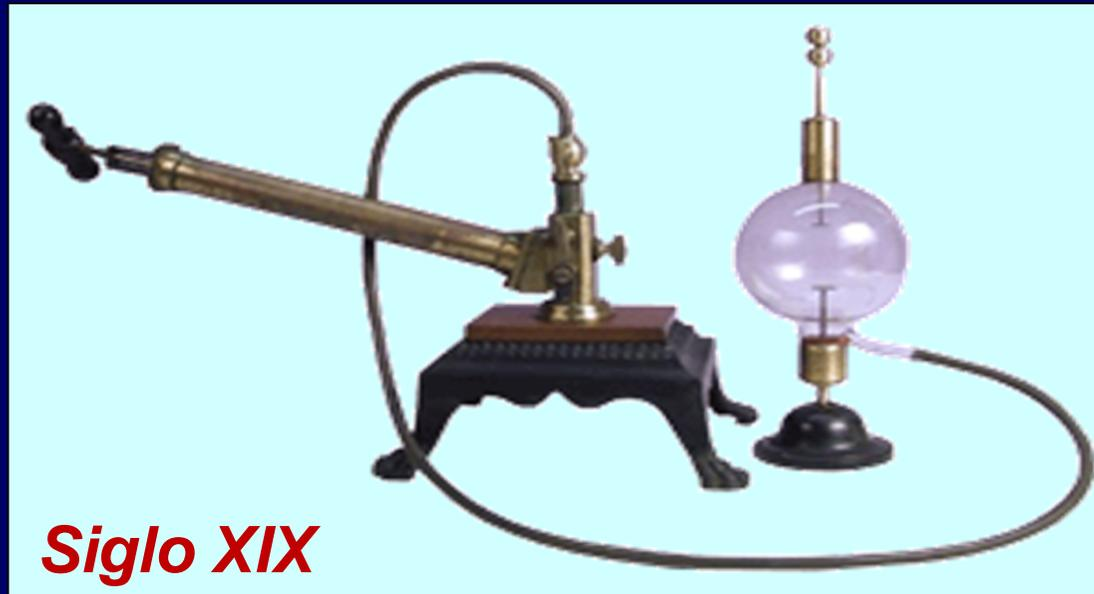
Célula con electrodos y Alto Voltaje + Bomba de Vacío (1880)
