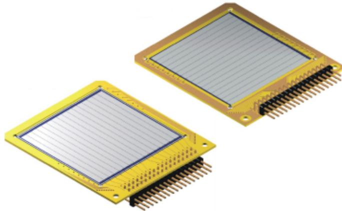
Figura 2.1: En la figura mostramos la cara trasera y delantera de los detectores DSSSD.[13]
