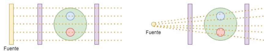
Figura 1.8: (izquierda) haz de protones paralelo. (derecha) haz de protones tipo ventilador.
