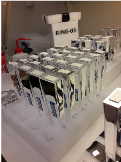
Figura 1.15: Aspecto de un cristal centelleador de CsI de la zona del IPhos, con el APD montado.
