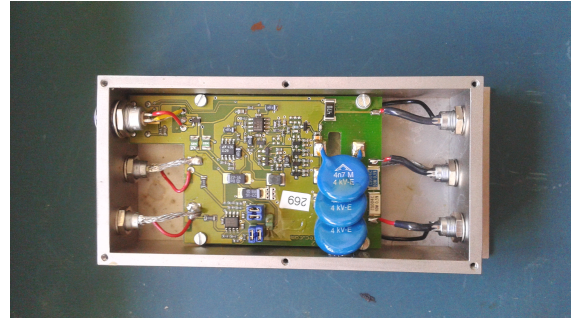
Figura 8: Preamplificador Mesytec MPR-1-Si [12].
