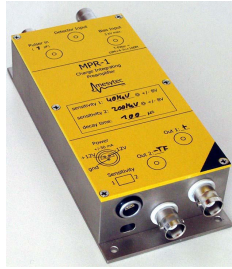
Figura 8: Preamplificador Mesytec MPR-1-Si [12].
