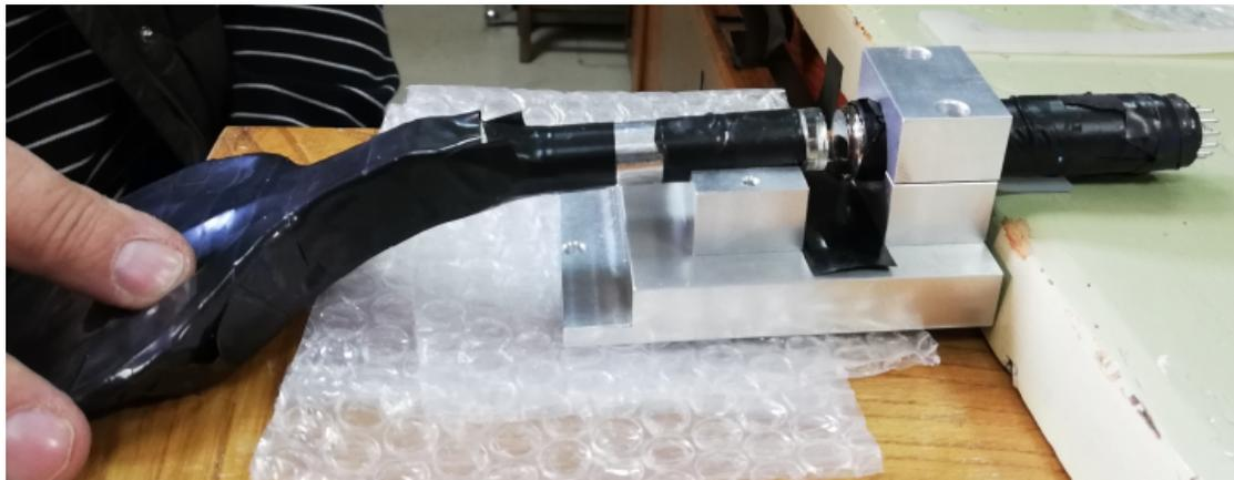
Figura 2.15: Fotografía en la que se muestra la pieza soporte junto a uno de los detectores plásticos (izquierda) y el PMT (derecha).
