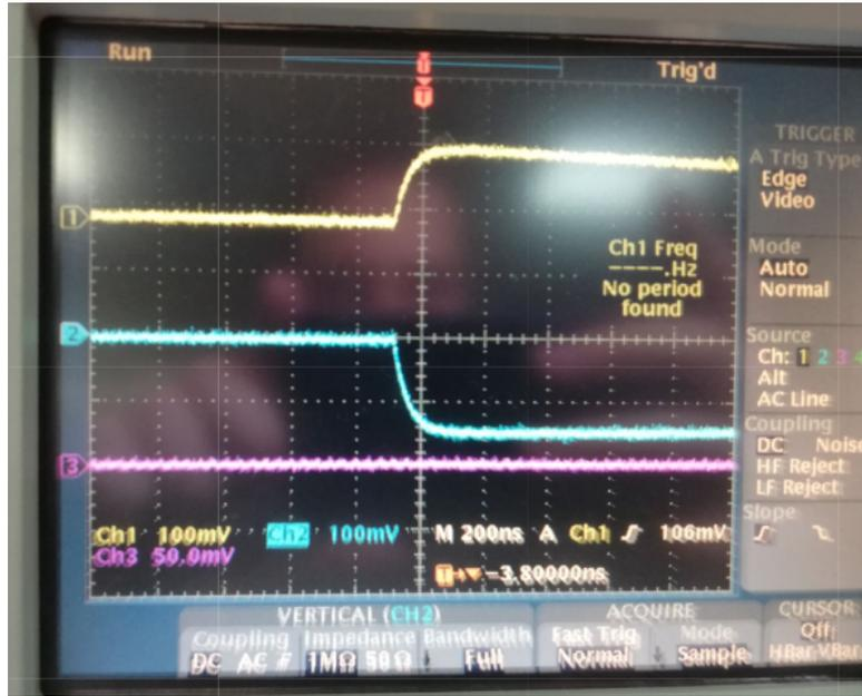
Figura 2.1: Señales de las salidas del ánodo de polaridad positiva (amarilla) y negativa del dínodo (azul) del fotomultiplicador del detector *LYSO* observadas en el osciloscopio usando las fuentes de la Tabla 2.2.
