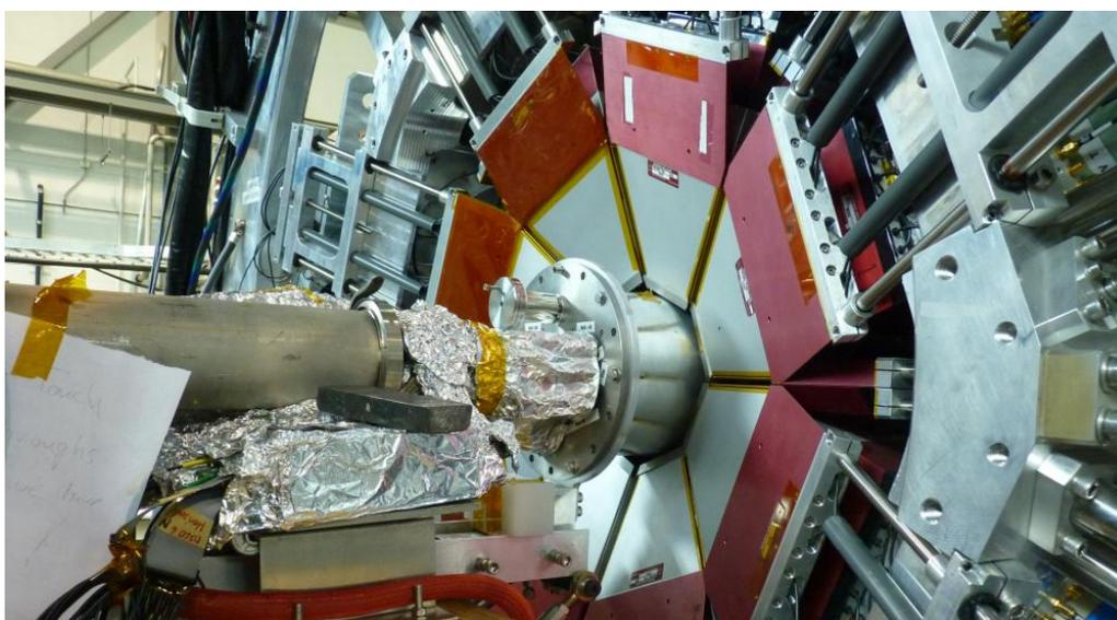
**Figure D.4:** Array de detectores TIGRESS cerrado alrededor de la cámara de reacción. En esta imagen pueden verse los clovers formando el anillo a  $90^\circ$ , rodeados por los cristales BGO para la supresión Compton.
